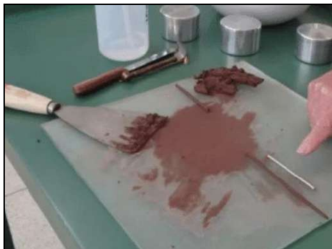
Figura 55 - Ensaio de Limite de Plasticidade.
