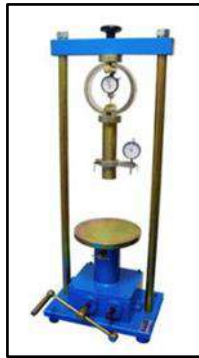
Figura 58 - Prensa Manual para Ensaio de CBR.
