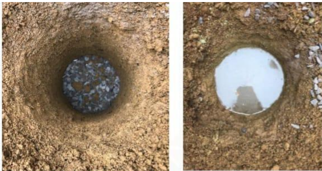
Figura 2: Ensaios de infiltração realizados na área do empreendimento Park Bela Vista.
